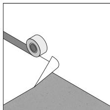
**1.** Все нахлесты полотен должны быть тщательно проклеены. Между собой плёнки проклеиваются при помощи двустороннего скотча **ONDUTISS Fix** или бутилкаучуковой монтажной ленты **ONDUTISS Butyl Tape**.
