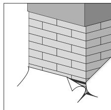
**2.** Для приклеивания плёнки к конструктивным элементам здания, парапетам, а также воздуховодам, вентиляционным и печным трубам применяется бутилкаучуковая монтажная лента **ONDUTISS Butyl Tape**.
